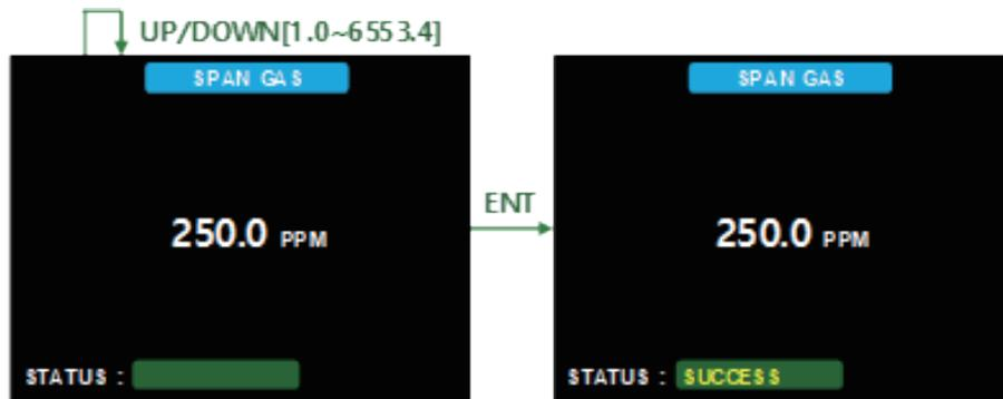
⑦ 그러면 화면이 자동으로 SPAN ADJUST로 이동한다. 표준 가스를 주입하고 LCD에 현재 측정된 값이 표시된다. 교정 중에는 SUCTION속도도 UP 키와 DOWN 키로 조정할 수 있다.
