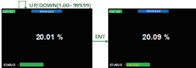
④ 그러면 화면이 자동으로 SPAN ADJUST로 이동한다. 표준 가스를 주입하고 LCD에 현재 측정된 값이 표시된다.
